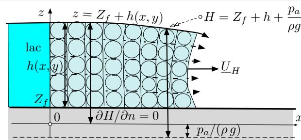
On démontre que  $\operatorname{div} \underline{q} = 0$  avec  $\underline{q} = h \underline{U}_H = (hU, hV)$  et donc :
