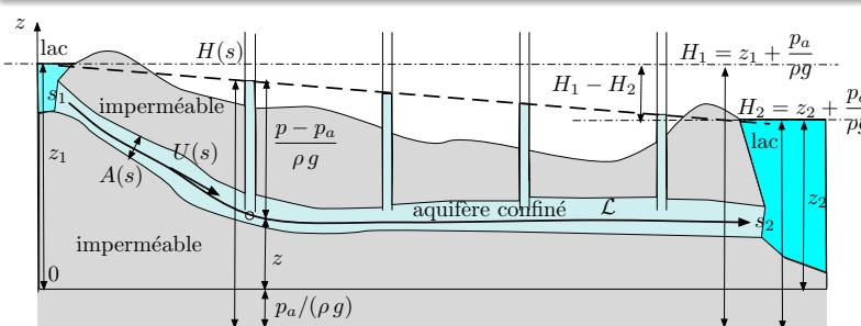
Section constante et cond. limites  $H(s_1) = H_1$  et  $H(s_2) = H_2$  :
