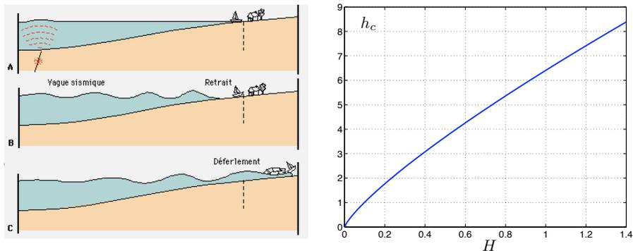
FIG. 1 – a) Schéma d'un tsunami. b) Fonction  $h_c(H) = h_0^{1/5} \left( \frac{H}{0.78} \right)^{4/5}$  pour  $h_0 = 4$  km.
