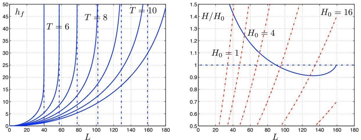
FIG. 2 – a) Fonction  $h_f(T, L) = \frac{L}{2\pi} \operatorname{argth} \left( \frac{2\pi L}{gT^2} \right)$  pour les périodes  $T = 5, 6, \dots, 11$  s. b) Fonction  $K_s(T, L) = H(T, L)/H_0 = \sqrt{\frac{gT^2}{4\pi L} \left\{ \frac{1}{2} + \frac{2\pi h_f(T, L)/L}{\sinh[4\pi h_f(T, L)/L]} \right\}^{-1/2}}$  pour la période  $T = 10$  s et critère de Miche  $H_c(T, L)/H_0 = 0.14 L \tanh[2\pi h_f(T, L)/L]/H_0$  pour les hauteurs au large  $H_0 = 1, 2, 4, \dots, 32$  m.
