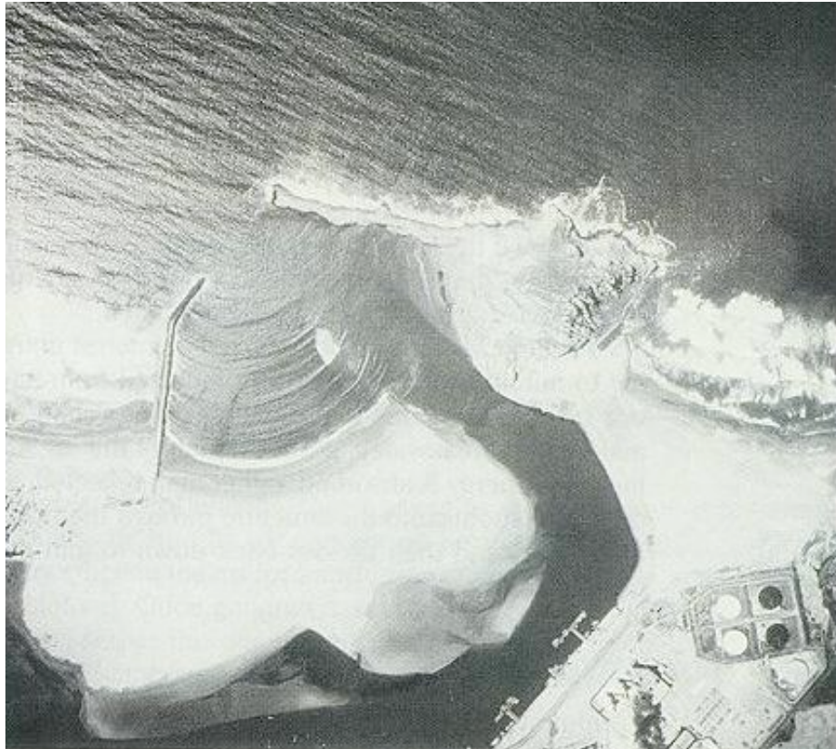
FIGURE 5.1 – Photo aérienne montrant la réfraction de la houle dans une port.
