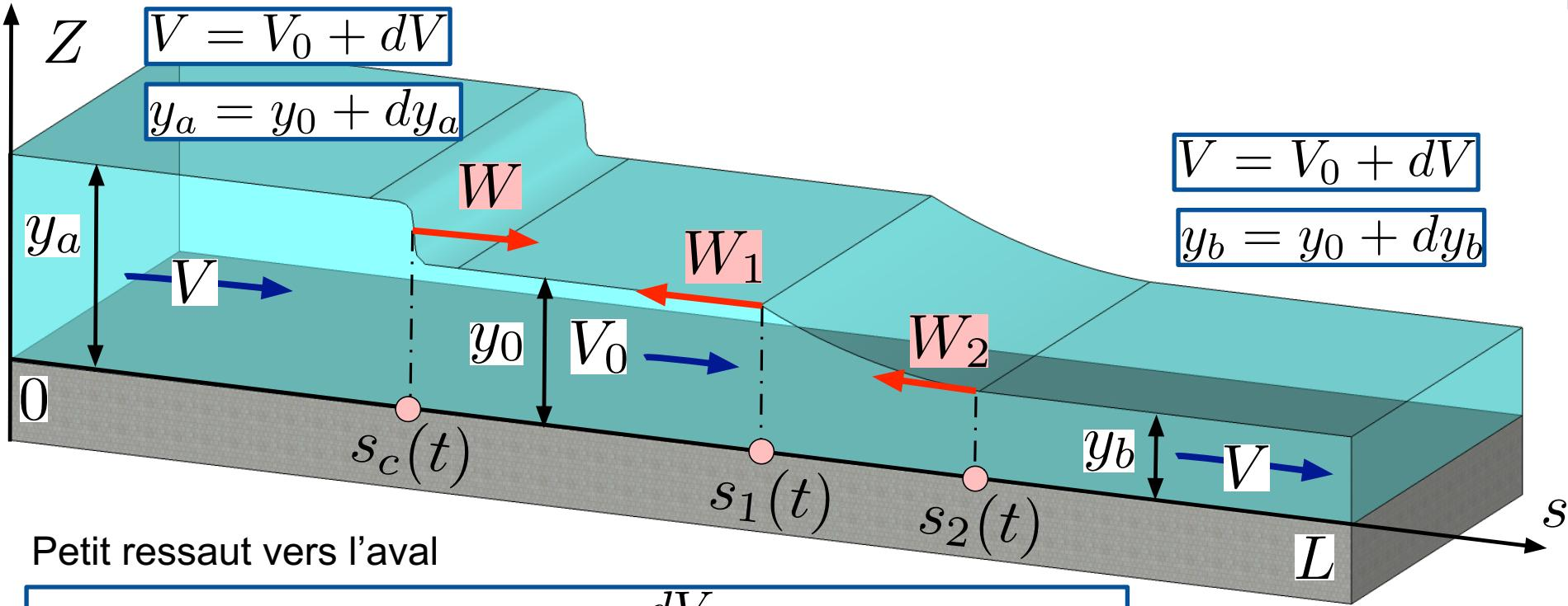
$$W \sim V_0 + c \quad \text{et} \quad dy_a \sim y_0 \frac{dV}{c} \quad \text{avec} \quad c = \sqrt{g y_0}$$
