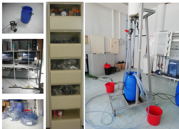
FIG. 14 – Chateau d'eau pour alimentation gravitaire d'un réseau.
