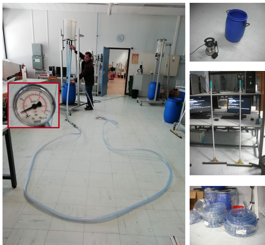
FIG. 13 – Mesure expérimentale de la rugosité d'un tuyau.
