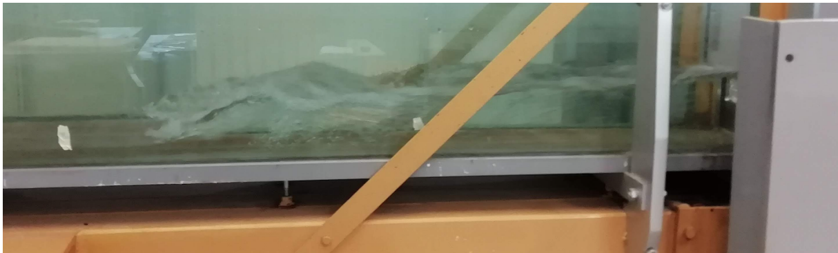
FIG. 26 – Ressaut dans le petit canal.
